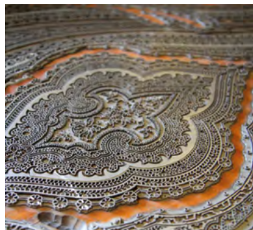
Planche d'impression Plombine - Lead-based printing block - Relief-Druckplatte aus Blei
